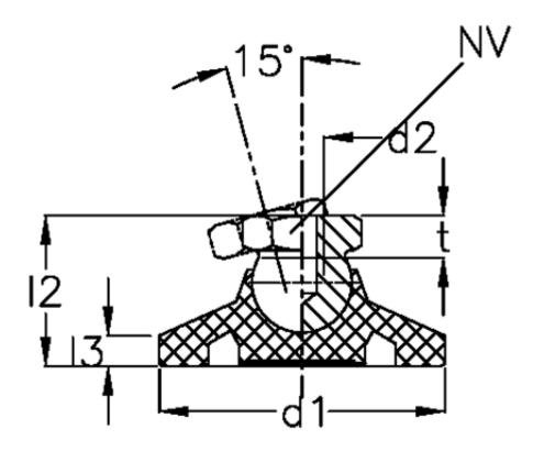
d1 = 32 d2 = M 8 l2 = 22.5 l3 = 5.0 NV = 12.0 Static load (N) = 7000 t min = 9.0
